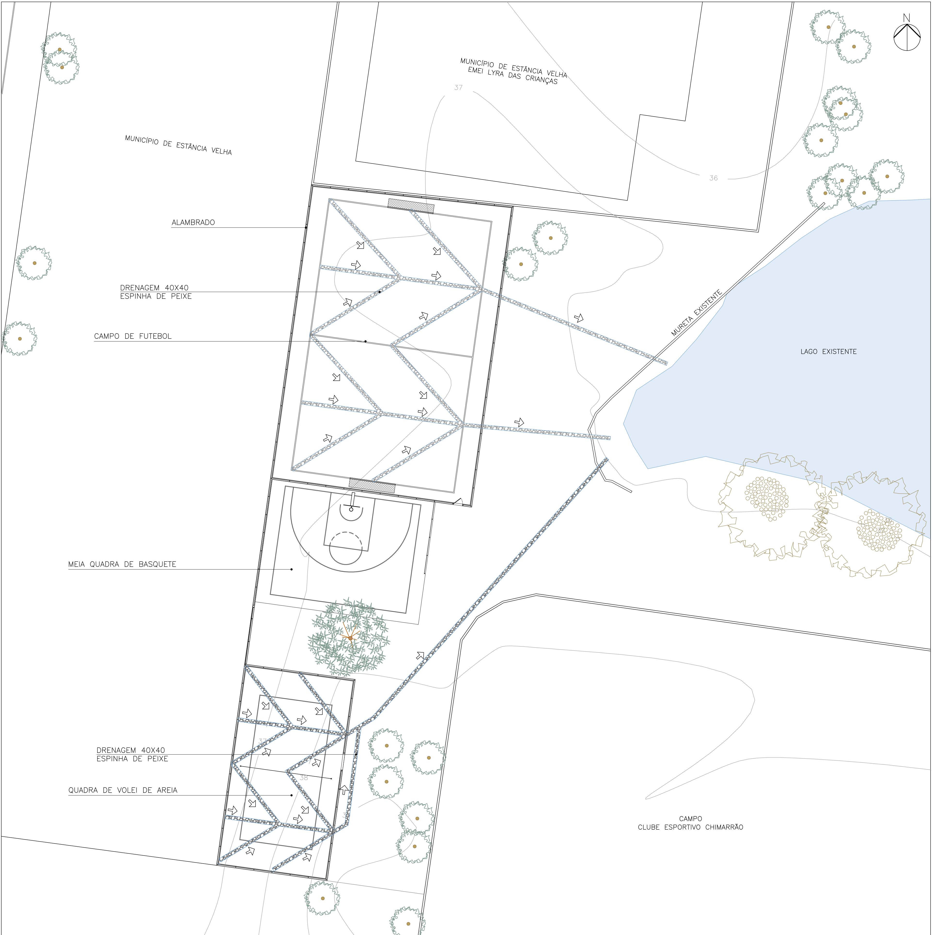
PLANTA BAIXA - DRENAGEM ESCALA 1:200
